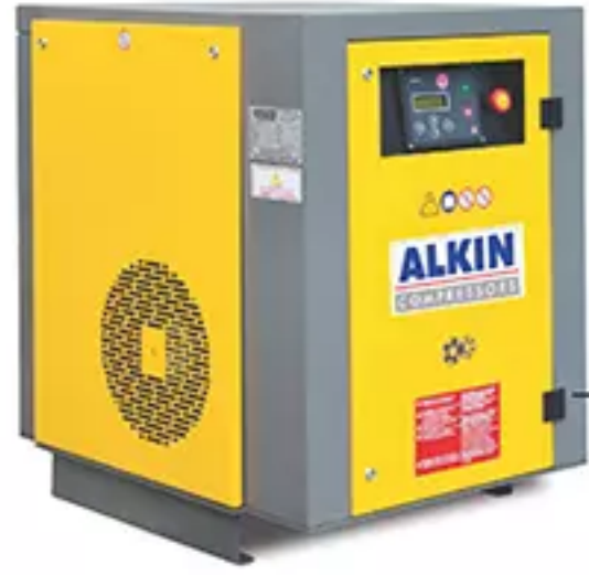
Vidalı Kompresör (ALK-3) Maks. çalışma basıncı: 10 bar Kapasite: 350 lt/dk Güç: 3.4 kW (440V/60Hz/3Faz) Hava soğutmalı
