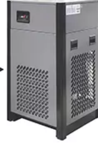
Hava Kurutucu Model: MKE-38 Kapasite: 38 m 3 /h Soğutucu tipi: R134a Hava soğutmalı Ağırlık: 32 kg Boyutlar: 413x363x557 mm
