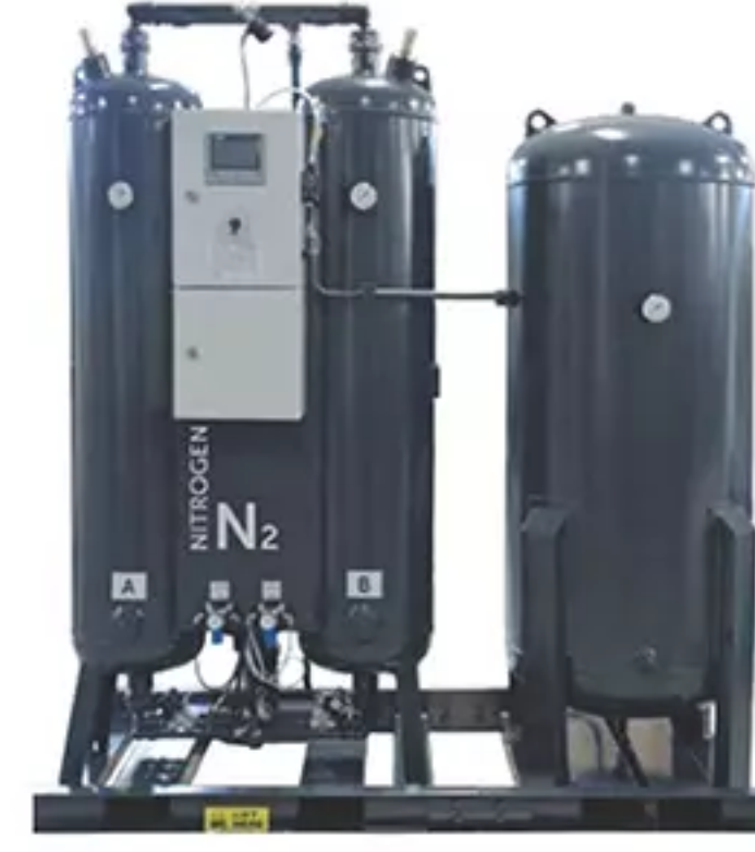
Azot Jeneratörü Tip: (PSA) Model: MNG-60 Kapasite: 6m 3 /h Saflık: > % 99.5 Giriş basıncı: 4-10 bar
